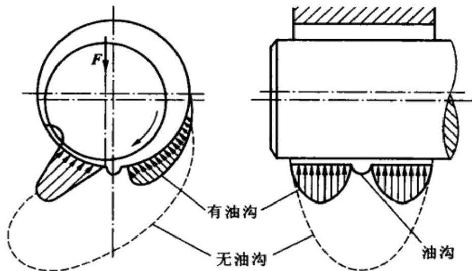
图 7-10 油沟对轴承承载能力的影响
