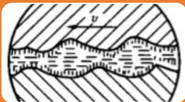
完全液体摩擦 ( $f = 0.001 \sim 0.008$ ) : 重要轴承采用这种摩擦状态
