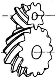
图 4-26 斜齿圆柱齿轮传动
